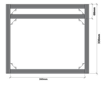
b. Top frame: 220mm×2, 360mm×2, Corner connector×4, Bolt M5\*10×8, Flat washer M5×8, Slide nut 20M5×8
